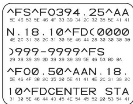
Рис. 16 • Этикетка теста диагностики обмена данными
