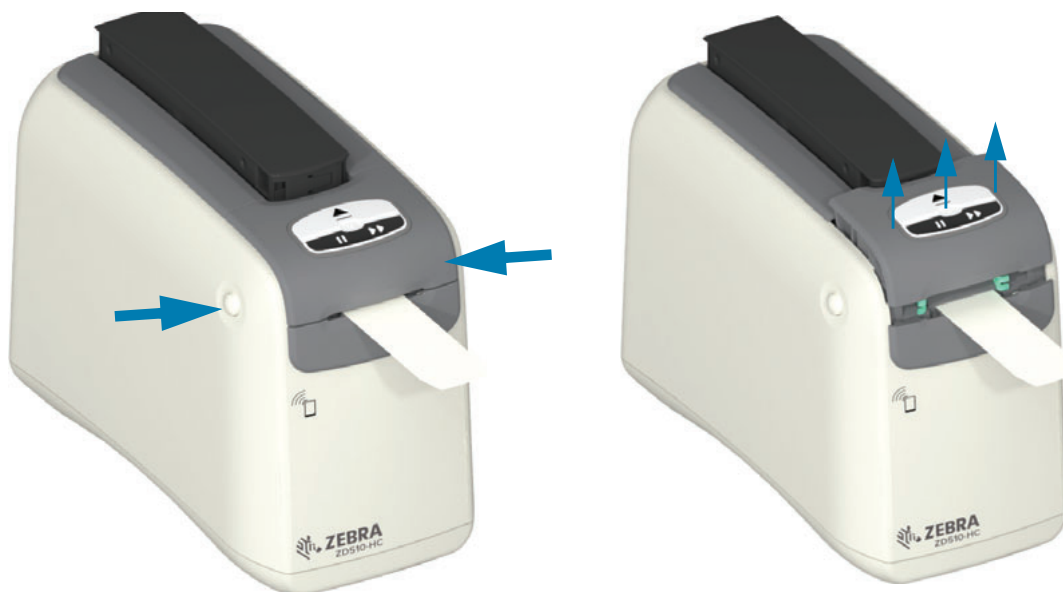
Рис.8 • Освобождение носителя, зажатого под верхней крышкой
